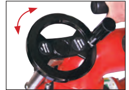
Manœuvrer le volant dans le sens anti-horaire pour arriver à proximité de la butée mobile de limitation à + 35°
